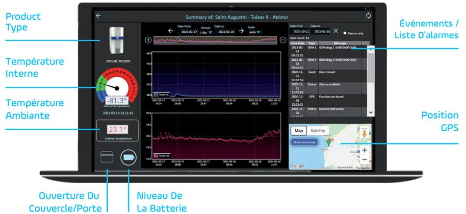
**2. Alerte en temps réel par SMS ou courrier électronique :** l'alarme peut être transmise à 3 destinataires différents par SMS ou courrier électronique à des numéros de téléphone ou des adresses électroniques préenregistrés.
